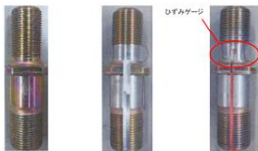
加工前 測定箇所ネジ部除去 ひずみゲージを貼付 写真-1 ホイールボルトへのひずみゲージ貼付け方法
